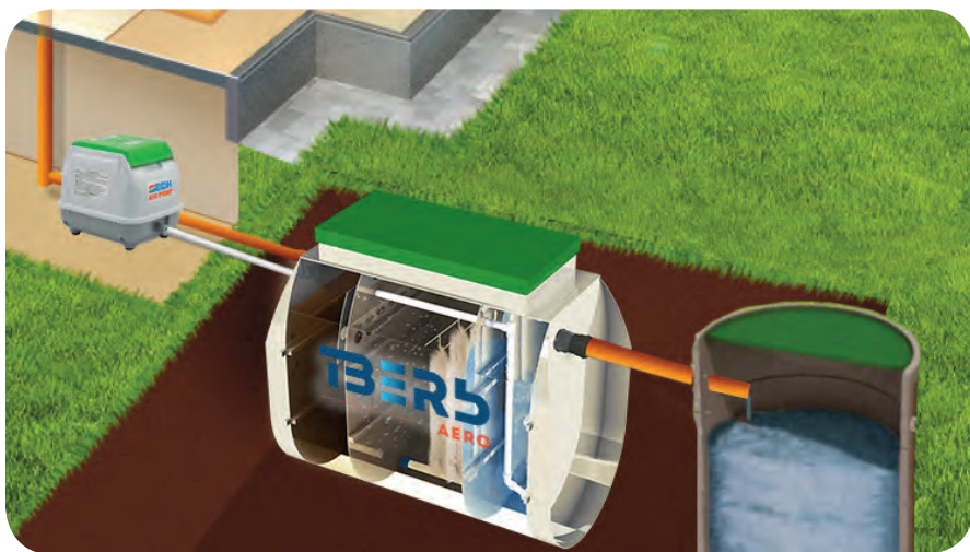
2. Схема с самотечным отводом очищенной воды
